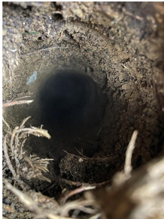
Slika 11: Vrtina za izvedbo ponikovalnega preizkusa
