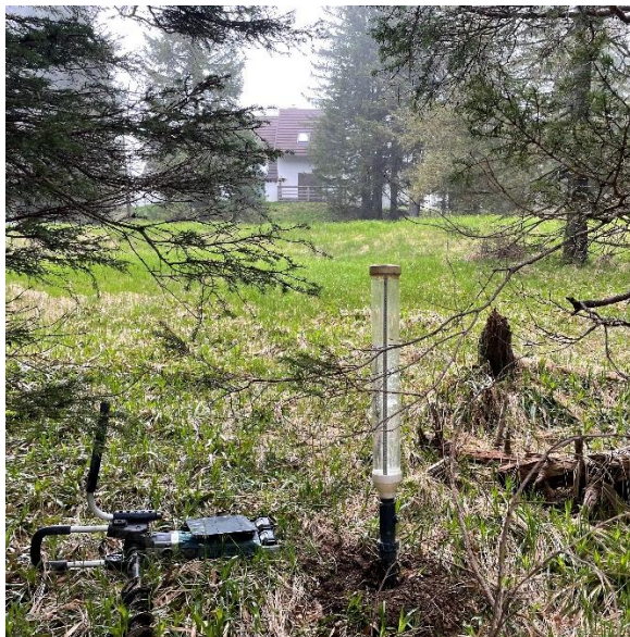
Slika 10: Garnitura za ponikovalni preizkus
